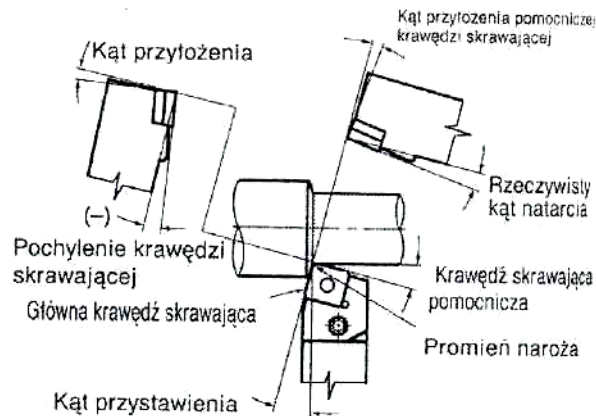
Rys. 8. Pochylenie krawędzi skrawającej
